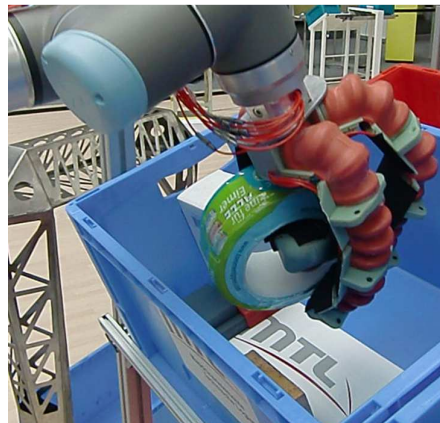
Universalgreifer mit Balgaktoren (rot) beim Griff in die Kiste
